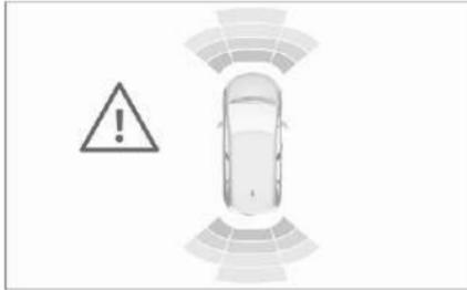
Кроме того, расстояние до находящегося сзади или спереди препятствия отображается на дисплее информационного центра водителя с помощью цветных сегментов.
