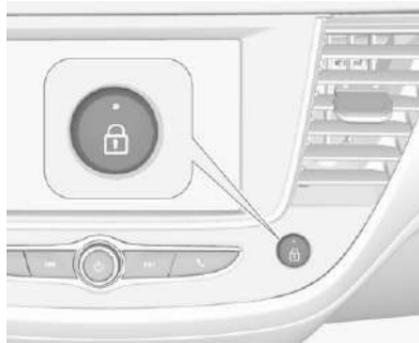
При включенном зажигании нажмите и удерживайте кнопку
