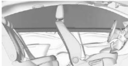
Надутые воздушные подушки безопасности амортизируют удар, тем самым они снижают опасность травмирования головы в случае серьезного бокового удара.
