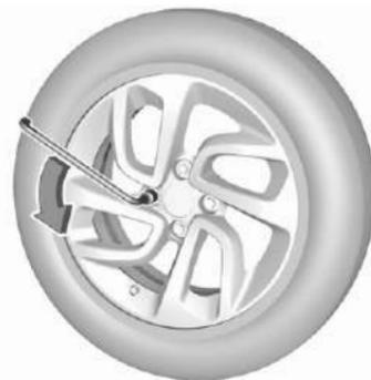
2. Баллонным ключом отверните каждый из колесных болтов на полоборота.
