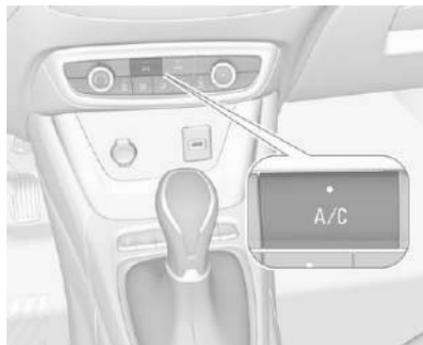
Нажмите клавишу **A/C**, чтобы включить режим охлаждения. Включение подтверждается подсветкой клавиши. Охлаждение работает только при включенном двигателе и вентиляторе климат-контроля.
