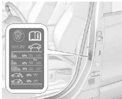
Табличка с данными о давлении в шинах расположена на торце левой двери и содержит информацию о типоразмерах шин, установленных изготовителем автомобиля, и о рекомендованном давлении воздуха в шинах.
