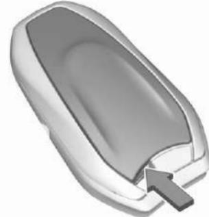
1. Подденьте крышку небольшой плоской отверткой, вставив ее в углубление.
