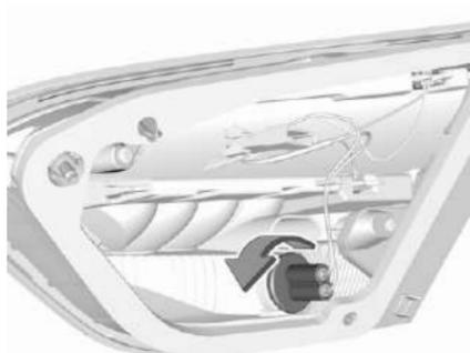
Извлеките держатель лампы заднего хода из корпуса заднего фонаря, повернув его против часовой стрелки.
