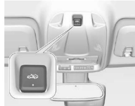
Следует отключить контроль салона, если в нем осталось животное, так как мощный ультразвуковой сигнал вреден для него, а движение животного может привести к срабатыванию противоугонной сигнализации. Систему также следует выключить при перевозке автомобиля на пароме или железнодорожным транспортом.
