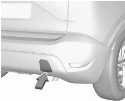
Оберните плоское жало отвертки тряпкой, чтобы не повредить лакокрасочное покрытие. Вставьте отвертку в щель у нижнего края заглушки. Освободить колпачок, аккуратно сдвинув отвертку вниз. Буксировочная проушина хранится в комплекте инструментов ⇨ 291.
