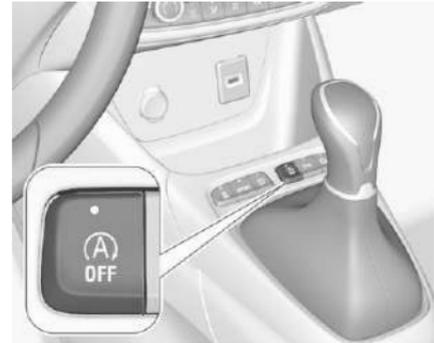
Чтобы принудительно отключить систему автоматической остановки и пуска двигателя, нажмите
