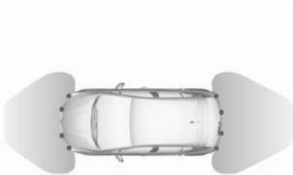
Система использует ультразвуковые датчики парковки, установленные в заднем и переднем бампере.
