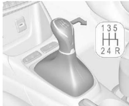
Чтобы включить передачу заднего хода на 5-ступенчатой коробке передач, когда автомобиль стоит на месте и двигатель работает на оборотах холостого хода, выжмите педаль сцепления и переместите рычаг селектора вправо и назад.
