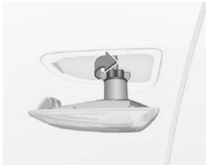
2. Поверните патрон лампы против часовой стрелки и извлеките из фонаря.
