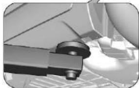
Место установки задней лапы подъемника — по центру в предусмотренном для этого месте на кузове.
