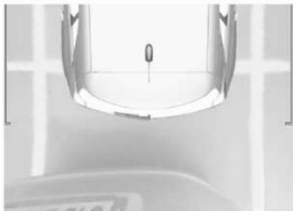
Камера записывает окружающую обстановку во время маневрирования для воссоздания вида на заднюю часть автомобиля сверху, чтобы водителю было проще объезжать расположенные поблизости препятствия. Данное представление доступно в автоматическом режиме и в меню выбора вида.
