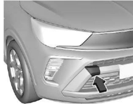
Оберните плоское жало отвертки тряпкой, чтобы не повредить лакокрасочное покрытие. Вставьте отвертку в щель у нижнего края заглушки. Освободить колпачок, аккуратно сдвинув отвертку вниз.
