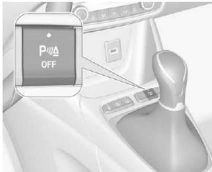
Система отключится после того, как передача заднего хода будет выключена. Нажмите клавишу **P OFF**, чтобы отключить систему вручную. Индикатор в клавише горит, если система выключена. Если система была отключена вручную, она не включится автоматически при следующем включении зажигания.
