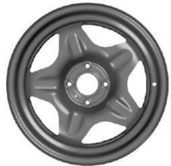
Момент затяжки болтов крепления специально разработанных стальных дисков — 130 Нм.
