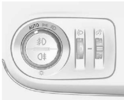
При включенном автоматическом управлении освещением и работающем двигателе осуществляется автоматический переход между режимами дневных ходовых огней и штатным режимом работы
