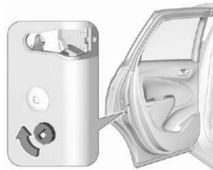
Чтобы заблокировать замки остальных дверей, сначала убедитесь, что блокировка от детей не активирована. Затем снимите черную крышку, вставив ключ и повернув его по часовой стрелке.
