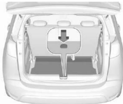
Поднимите крышку пола багажного отделения за углубление, чтобы достать аварийный набор.
