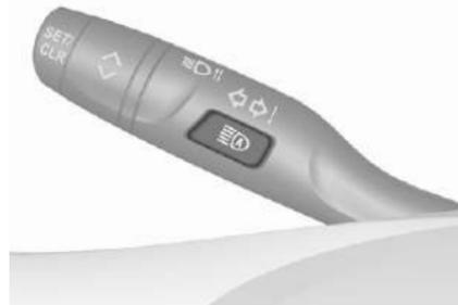
Чтобы включить систему автоматического переключения дальнего света, нажмите  $\equiv D$ . В кнопке загорится светодиод.
