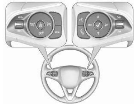
Управление круиз-контролем и ограничителем скорости осуществляется с помощью левого блока клавиш на рулевом колесе.
