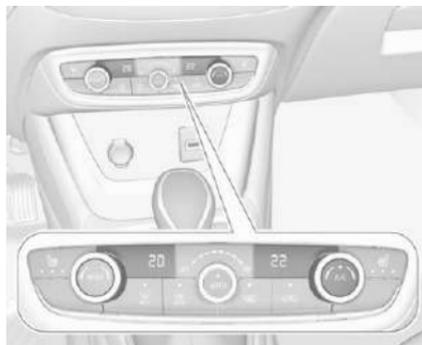
Нажмите клавишу **A/C**, чтобы включить режим охлаждения. В кнопке загорается светодиод, указывая, что система работает. Охлаждение
