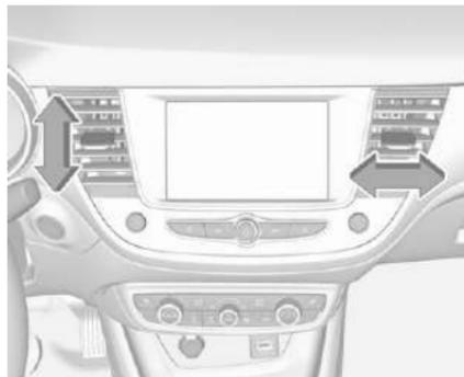
Наклоняя и поворачивая решетку, установите требуемое направление потока воздуха.
