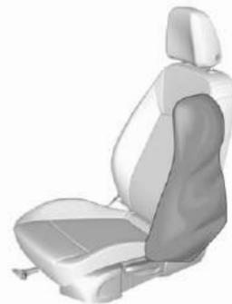
Надутые воздушные подушки безопасности амортизируют удар, тем самым они снижают опасность травмирования верхней части туловища и таза в случае серьезного бокового удара.
