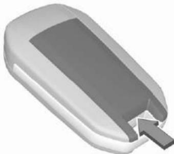
1. Чтобы снять крышку, вставьте небольшую плоскую отвертку между крышкой и корпусом радиобрелока (ПДУ).
