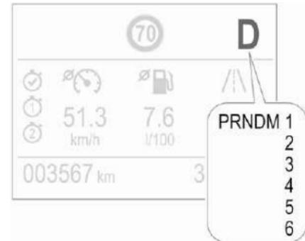
На дисплей информационного центра водителя выводится режим ее работы и выбранная передача.
