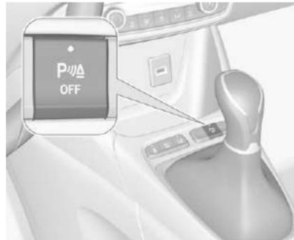
Система отключится автоматически, когда скорость движения автомобиля превысит 10 км/ч или автомобиль простоит без движения более трех секунд при выбранной передаче переднего хода, а также при отсутствии препятствий.
