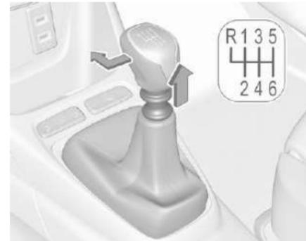
Для включения передачи заднего хода на 6-ступенчатой коробке передач, когда автомобиль стоит на месте и двигатель работает на оборотах холостого хода, выжмите педаль сцепления, потяните кольцо под рычагом переключения передач и переместите рычаг до упора влево и вперед.
