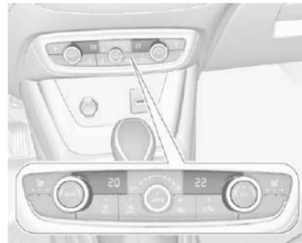
Установите предварительно выбранную температуру отдельно для водителя и переднего пассажира на желаемое значение с помощью левой и правой поворотной ручки. С помощью ручки со стороны пассажира можно настроить температуру в зоне пассажира. Поворотная ручка со стороны водителя изменяет температуру со стороны водителя или с обеих сторон, в зависимости от активации синхронизации (**MONO**) в меню настройки параметров
