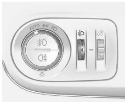
Чтобы подстроить наклон света фар в соответствии с загрузкой автомобиля во избежание ослепления встречных водителей: поверните колесико с накаткой  $\text{D}$  в требуемое положение.
