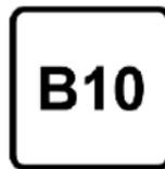
Дизельное топливо, соответствующее стандарту EN16734, смешанное с биотопливом, соответствующим стандарту EN14214 (допускается содержание до 10 % метиловых эфиров жирных кислот).
