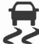
После пуска двигателя электронная система динамической стабилизации и система контроля тягового усилия готовы к работе, как только гаснет индикатор
