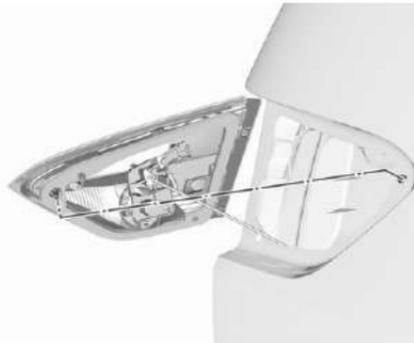
2. Установите фонарь на заднюю дверь багажного отделения.
