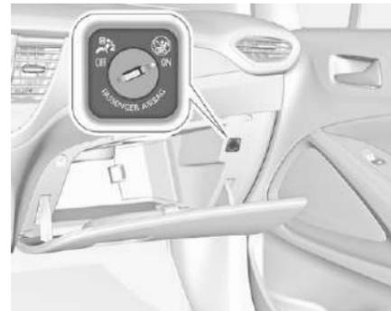
Систему подушки безопасности переднего пассажира можно отключить с помощью выключателя с ключом на стороне пассажира в перчаточном ящике.
