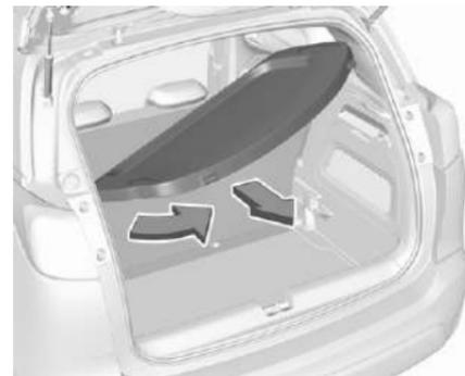
Приподнимите крышку, слегка наклоните и поверните ее.
