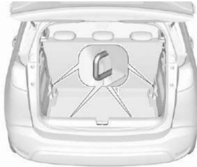
Крепежные проушины предназначены для предотвращения смещения предметов, например, с помощью крепежных ремней или багажной сетки.
