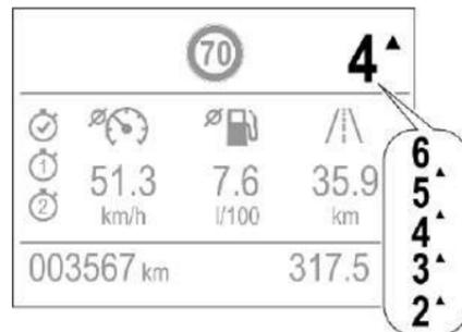
Если для экономии топлива рекомендуется переключение на более высокую передачу, отображается ▲ вместе с номером той передачи, которую рекомендуется включить.
