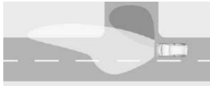
При повороте, в зависимости от угла поворота рулевого колеса и от того, включен ли указатель поворота, включается дополнительная секция светодиодов, подсвечивающая участок дороги с той стороны, в которую осуществляется поворот. Включается автоматически до скорости 40 км/ч.
