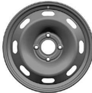
Момент затяжки болтов крепления обычных стальных дисков — 110 Нм.
