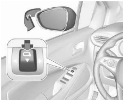
Потяните назад клавишу складывания наружных зеркал. При этом оба наружных зеркала складываются.
