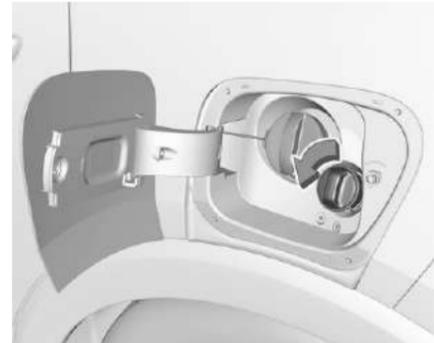
4. Скрутите предохранительную пробку с заправочной горловины.
