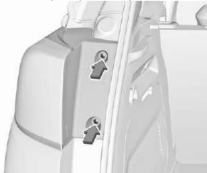
1. Выкрутите два винта крепления фонаря.
