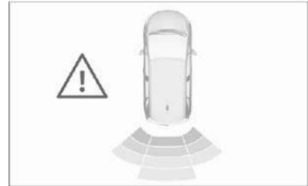
Кроме того, расстояние до находящегося сзади препятствия отображается на дисплее информационного центра водителя  $\rightarrow$  91 с помощью цветных сегментов. Когда расстояние до препятствия становится опасным, появляется значок ⚠
