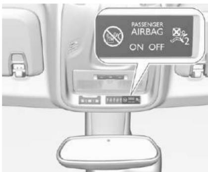
Если после включения зажигания примерно на 60 секунд загорается индикатор ☑ ON, система надувных подушек безопасности переднего пассажира сработает в случае столкновения.
