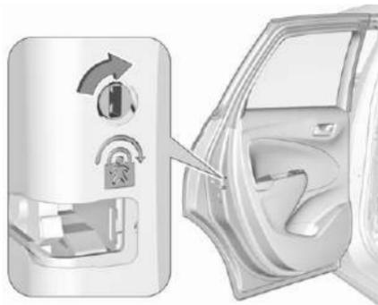
Поверните ключом красный флажок блокировки замка в задней двери в заблокированное положение. Дверь открыть изнутри невозможно.
