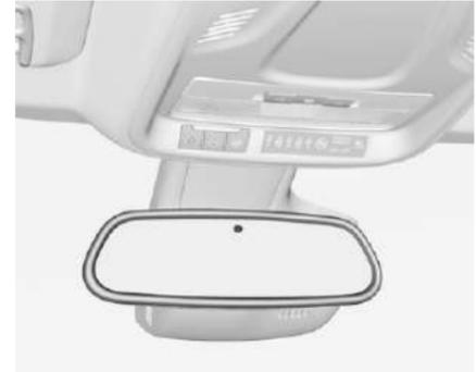
При движении в темное время суток автоматически снижается ослепление водителя светом фар движущегося сзади транспорта.
