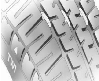
Законодательно разрешенная минимальная глубина канавки протектора (1,6 мм) достигается, когда протектор изнашивается до появления индикаторов износа протектора (TWI). Их положение указывается маркерами на боковой стенке.
