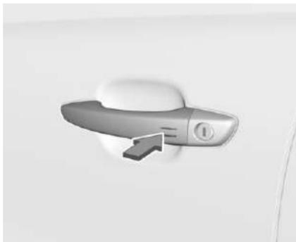
Система управления электронным ключом: При разблокировании замков дверей нажатием на наружную ручку одной из передних дверей в отмеченном месте противоугонная сигнализация отключается.
