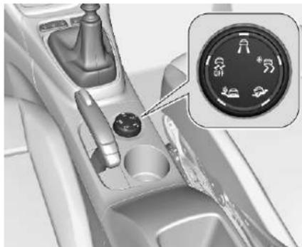
Система селективного управления подвеской позволяет поворотом переключателя выбрать один из пяти режимов движения:
