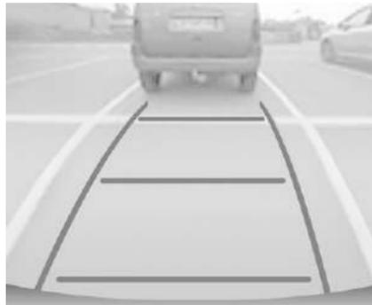
На дисплее отображается пространство позади автомобиля. Расстояние между боковыми линиями направляющей разметки соответствует ширине автомобиля с разложенными зеркалами. Направление линий изменяется в зависимости от положения рулевого колеса.
