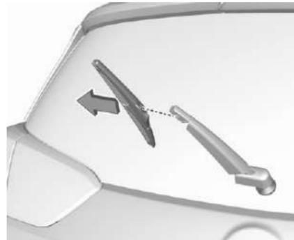
Поднять рычаг стеклоочистителя. Отсоедините щетку стеклоочистителя, как показано на рисунке, и снимите ее.
